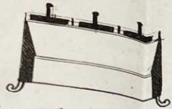
Coupe longitudinale du fourneau potager.
